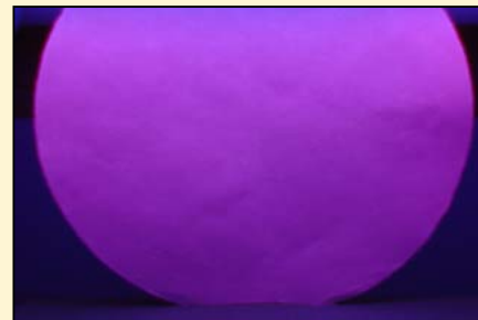
Formettes sous UV : Cellulose non traitée
